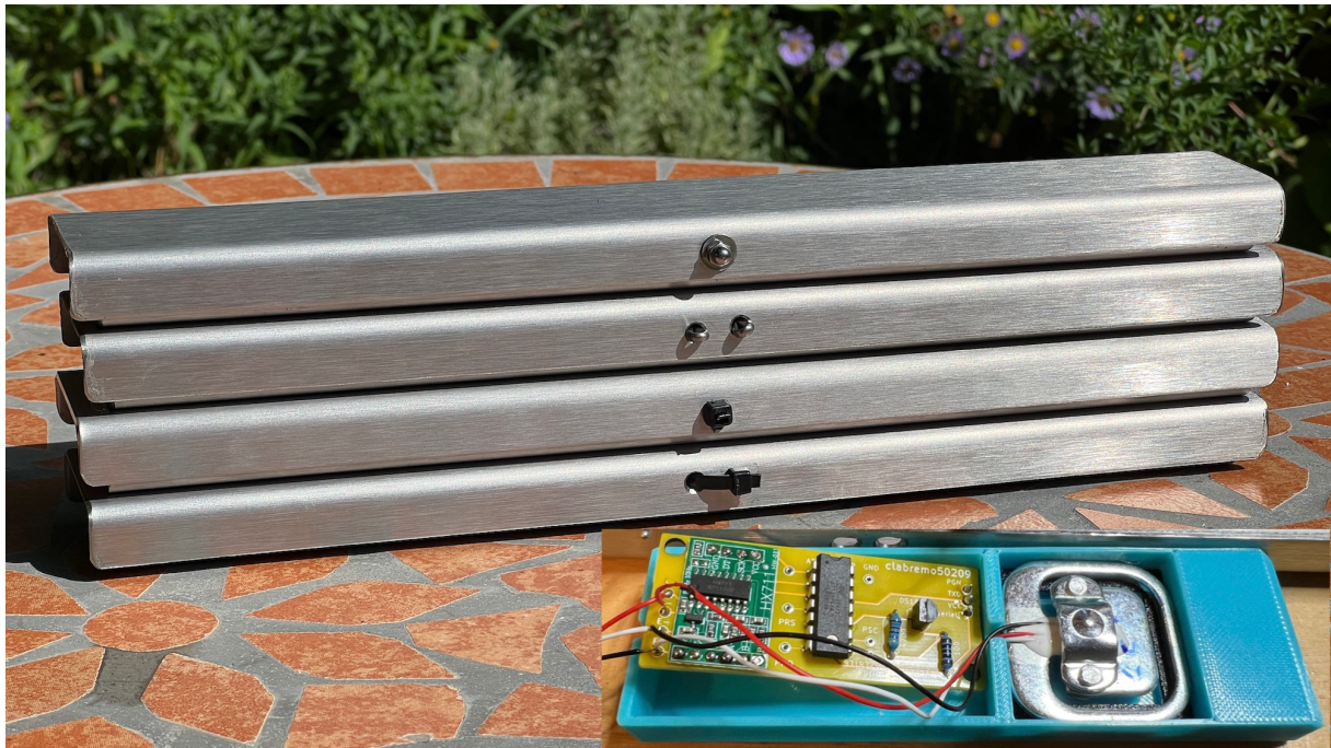
Abb. 1: Vier Prototypen des Trachtschätzers mit unterschiedlichen Transportsicherungen. Das Gehäuse besteht aus Edelstahl, die Gesamtkonstruktion hält das Überfahren mit einem Transporter aus. Rechts unten im Bild ist das Innenleben mit einer Flachwägezelle und dem im Projekt entwickelten PCB eingeblendet. Die Daten übergibt der Trachtschätzer mittels einer seriellen Schnittstelle und einem einfachen Protokoll, so dass nahezu beliebige Microcontroller für die Weiterverarbeitung der Daten verwendet werden können. Beispielprogramme gibt es für den ESP8266.
